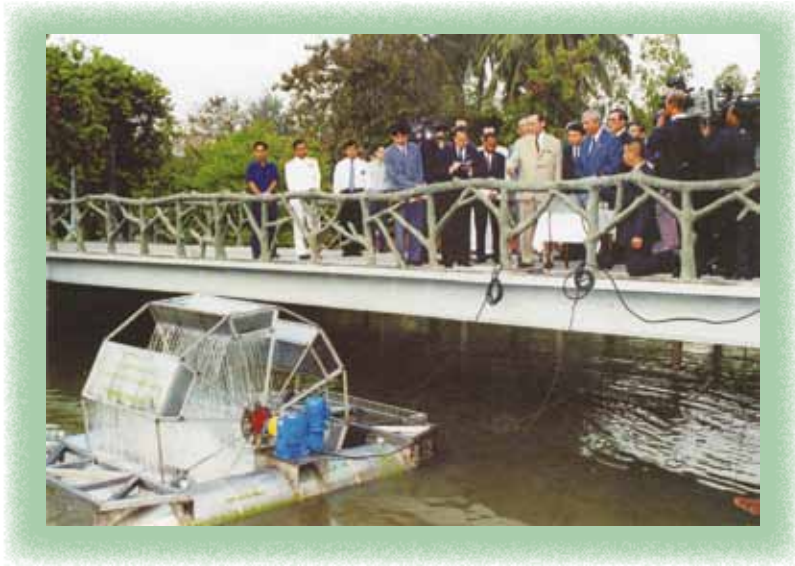
พระบาทสมเด็จพระเจ้าอยู่หัวทรงนำภูมิปัญญาชาวบ้านมาเป็นแนวพระราชดำริในการสร้างเครื่องเค็มอากาศในน้ำขึ้น นั่นก็คือ พระองค์ทรงใช้ "หลุก" อุปกรณ์คล้ายกังหันริมน้ำ
