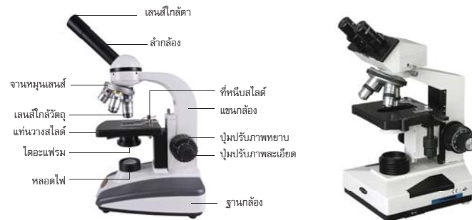
รูปที่ 1.17 ส่วนประกอบของกล้องจุลทรรศน์แบบใช้เลนส์ใกล้ตา 1 อัน และกล้องจุลทรรศน์แบบใช้เลนส์ใกล้ตา 2 อัน
