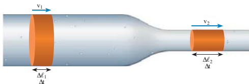
รูปที่ 1.19 หลอดของการไหลที่มีพื้นที่หน้าตัดไม่เท่ากัน
