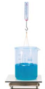
รูปที่ 1.15 การวัดแรงตึงผิว
