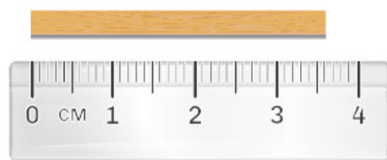
การวัดความยาวของแท่งไม้ โดยใช้บรรทัดที่มีสเกลละเอียดสุดที่ 0.1 เซนติเมตร
