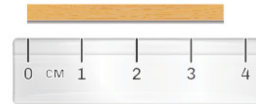
การวัดความยาวของแท่งไม้ โดยใช้มรววัดที่มีสเกลละเอียดสุดที่ 1 เซนติเมตร
