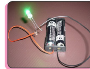
ภาพที่ 3.25 การต่อหลอดไฟ LED
