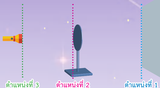
ภาพที่ 1.8 การวางตำแหน่งในการทดลองการเกิดเงามืดเงามัว
