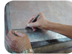
รูปที่ 1.1 การเลย์เอาต์ (Lay Out) แผ่นเหล็กอบสังกะสี
