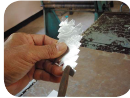
รูปที่ 1.6 แสดงวิธีการตัดด้วยกรรไกรตัดตรง
