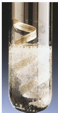
รูปที่ 1.16 ปฏิกิริยาระหว่างสารละลายกรดกับโลหะแมกนีเซียมเกิดฟองแก๊สไฮโดรเจน [2]
