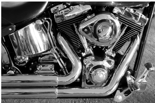
รูปที่ 1.40 ชิ้นส่วนเครื่องยนต์ที่เคลือบด้วยโครเมียม
