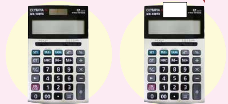
ภาพที่ 4.5 เซลล์สุริยะของเครื่องคิดเลข
