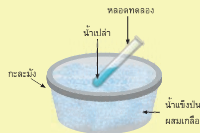
ภาพที่ 4.4 นำหลอดทดลองที่ใส่น้ำในกะละมังที่ใส่น้ำแข็งปนที่ผสมเกลือ
