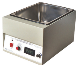
▲ ภาพที่ 1.7 อ่างน้ำควบคุมอุณหภูมิ (water bath) อ่างให้ความร้อน โดยสามารถควบคุมอุณหภูมิตั้งแต่ 15 องศาเซลเซียส แต่ไม่เกินอุณหภูมิ 100 องศาเซลเซียส ที่มา : คลังภาพ อจท.
