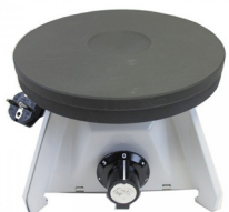
▲ ภาพที่ 1.6 เตาให้ความร้อน (hotplates) อุปกรณ์ให้ความร้อนที่ออกแบบมาสำหรับเครื่องแก้วที่มีก้นแบน เช่น ปีกเกอร์ ซึ่งใช้สำหรับต้มสาร หรืออุ่นสารละลายที่อุณหภูมิไม่เกิน 400 องศาเซลเซียส ที่มา : คลังภาพ อจท.
