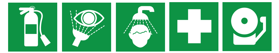
ถังดับเพลิง ล้างตาฉุกเฉิน ชาร์ล้างฉุกเฉิน ปฐมพยาบาล กระดิ่งเตือนภัย
