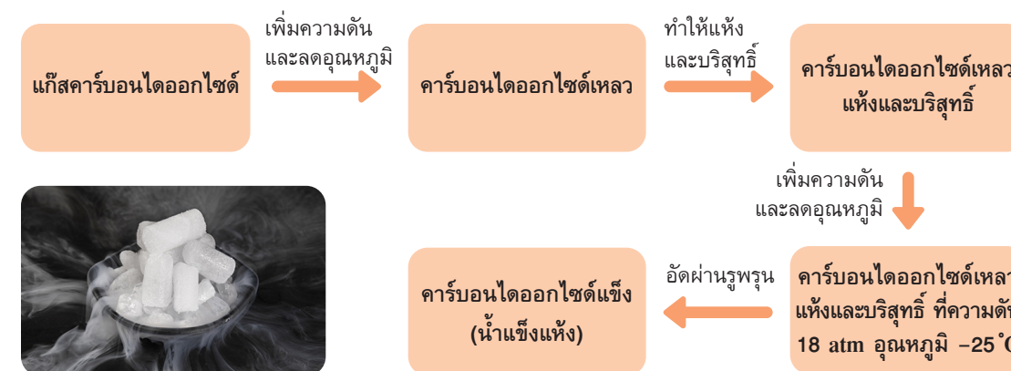
▲ ภาพที่ 1.25 แผนภาพแสดงขั้นตอนการผลิตน้ำแข็งแห้ง ที่มา : คลังภาพ อจท.
