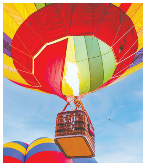
▲ ภาพที่ 1.29 บอลูนสามารถลอยอยู่ในอากาศได้โดยอาศัยหลักการตามทฤษฎีจลน์ของแก๊ส และกฎของชาร์ล ที่มา : คลังภาพ อจท.
