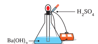
▲ ภาพที่ 4.6 การทดลองปฏิกิริยาระหว่างสารละลาย H_2SO_4 และสารละลาย Ba(OH)_2 ที่มา : คลังภาพ อจท.
