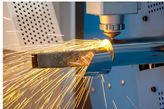
▲ ภาพที่ 5.27 เลเซอร์สามารถเจาะทะลุโลหะได้ จึงนำมาใช้ตัดหรือเจาะวัสดุต่าง ๆ ซึ่งจะได้ผลงานที่มีความละเอียดสูงมาก ที่มา : คลังภาพ อจท.
