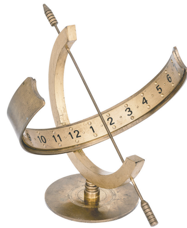
▲ ภาพที่ 4.24 นาฬิกาแดดแบบศูนย์สูตร ที่มา : คลังภาพ อจท.
