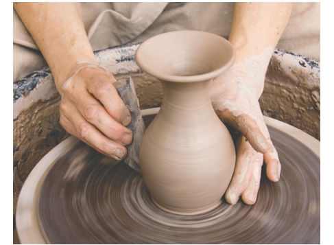
▲ ภาพที่ 3.6 การนำดินเหนียวมาปั้นแล้วนำไปเผาจนเป็นเซรามิก ที่มา : คลังภาพ อจท.
