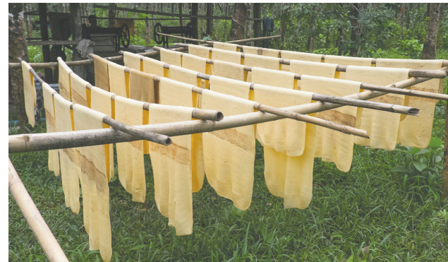
▲ ภาพที่ 3.18 แผ่นยางที่ได้จากการนำน้ำยางพาราไปผ่านกระบวนการทำแผ่นยางก่อนนำไปใช้งาน ที่มา : คลังภาพ อจท.
