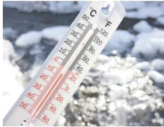
▲ ภาพที่ 1.20 เทอร์มอมิเตอร์เป็นเครื่องมือวัดอุณหภูมิอากาศ ที่มา : คลังภาพ อจท.
