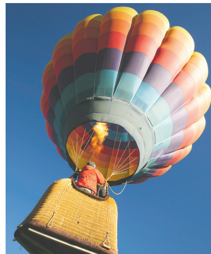
▲ ภาพที่ 4.9 ความร้อนทำให้อากาศเกิดการขยายตัวจึงทำให้อากาศลอยตัวสูงขึ้น ที่มา : คลังภาพ อจท.
