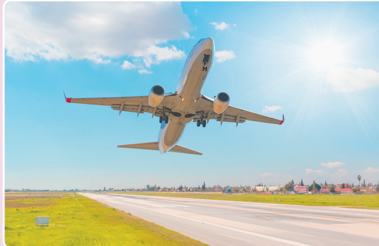
▲ ภาพที่ 4.30 เมื่ออุณหภูมิของอากาศสูงขึ้น อากาศจะมีความหนาแน่นลดลง ส่งผลให้แรงยกที่อยู่ใต้ปีกเครื่องบินลดต่ำลงไปด้วย ที่มา : คลังภาพ อจท.
