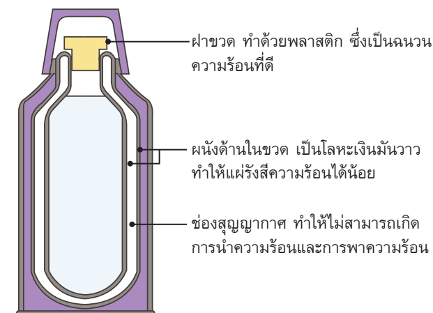
▲ ภาพที่ 4.29 ผนังด้านในกระติกน้ำร้อนทำจากวัสดุที่มีผิวมันวาว ซึ่งแผ่ความร้อนได้น้อย ที่มา : คลังภาพ อจท.
