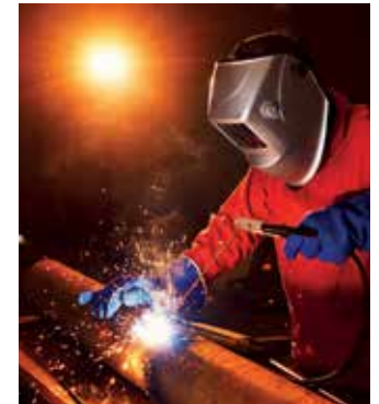
รูป 1.10 กระบวนการตัดและเชื่อมเหล็กใช้ความร้อนสูงจากการเผาไหม้แก๊สออกซิเจนและแก๊สอะเซทิลีน
