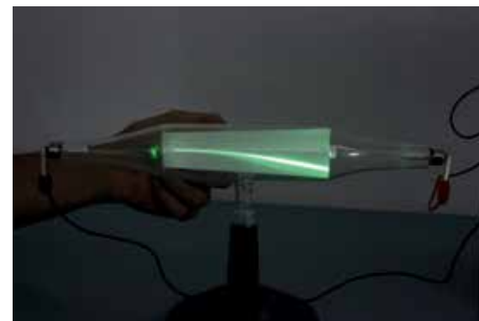
ก. การเบนของแนวการเคลื่อนที่ของอิเล็กตรอน เมื่อนำขั้วใต้ของแท่งแม่เหล็กเข้าใกล้
