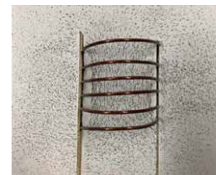
รูป 15.16 การเรียงตัวของผงเหล็กเมื่อมีกระแสไฟฟ้าผ่านโซเลนอยด์
