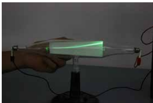
ก. การเบนของแนวการเคลื่อนที่ของอิเล็กตรอน เมื่อนำขั้วเหนือของแท่งแม่เหล็กเข้าใกล้
