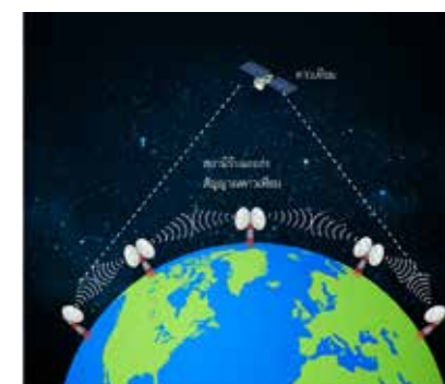
รูป 18.28 การส่งและรับสัญญาณดาวเทียมโดยใช้ไมโครเวฟ
