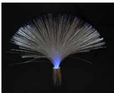
ก. การนำแสงของเส้นใยนำแสง
