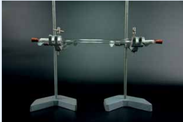
การจัดอุปกรณ์สำหรับการทดลองการแพร่ของแก๊ส
