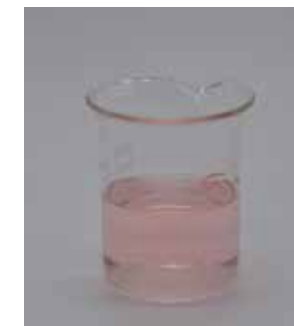
(ก) หยดยูนิเวอร์ซัลอินดิเคเตอร์และเทียบสีของสารละลายกับแถบสีที่ pH ต่าง ๆ
