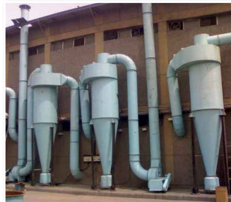
รูป 1.8 ไซโคลนในโรงงานอุตสาหกรรมและระบบทำงานภายใน
