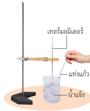
ภาพที่ 1.7 การหาจุดหลอมเหลวของน้ำแข็ง
