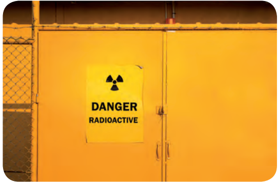
รูปที่ 1.23 การติดป้ายสัญลักษณ์รังสีในบริเวณพื้นที่ที่มีการปฏิบัติงานเกี่ยวกับสารกัมมันตรังสี ที่มา: คลังภาพ วพ.
