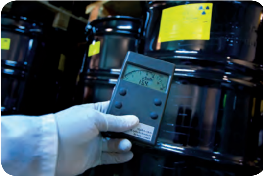
รูปที่ 1.22 การใช้เครื่องไกเกอร์มูลเลอร์เคาน์เตอร์ตรวจสอบการแผ่รังสีของสารกัมมันตรังสี ที่มา: คลังภาพ วพ.
