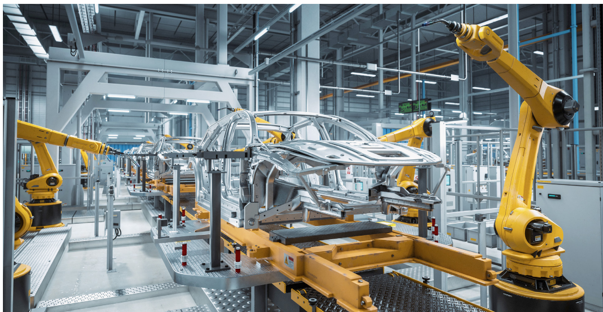
ภาพที่ 1.14 การนำเทคโนโลยีแขนหุ่นยนต์มาช่วยในการผลิตและประกอบชิ้นส่วนรถยนต์
