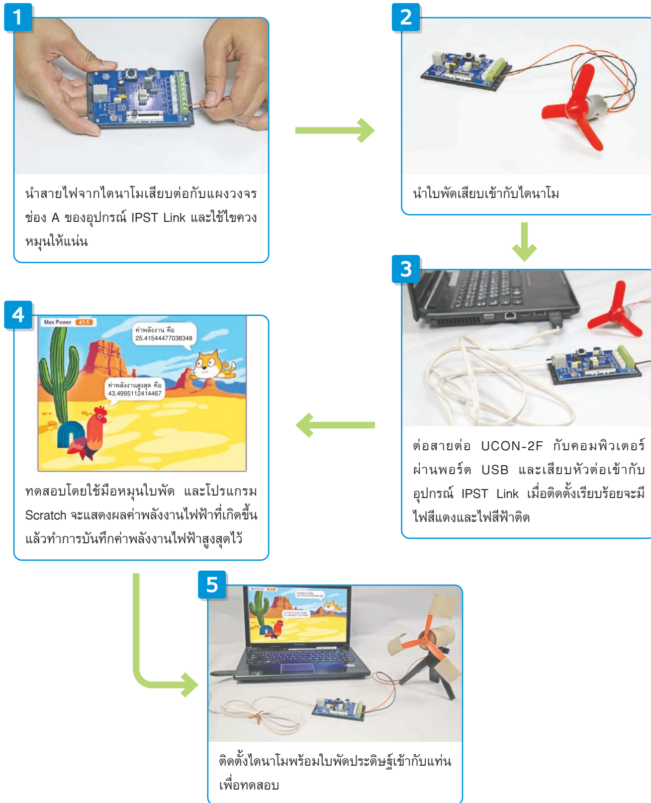
ภาพที่ 1.37 ลำดับขั้นตอนการดำเนินการเชื่อมต่ออุปกรณ์เพื่อนำไปทดสอบการผลิตพลังงานไฟฟ้า
