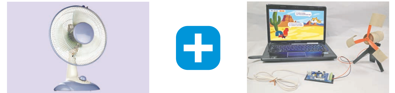
ภาพที่ 1.38 การใช้พัดลมทดสอบการผลิตไฟฟ้าจากกังหันลมที่เชื่อมต่อกับอุปกรณ์ IPST Link
