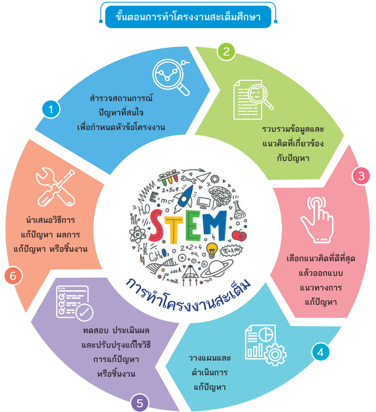
ภาพที่ 1.25 แผนภาพแสดงขั้นตอนการทำโครงงานสะเต็มบนพื้นฐานของกระบวนการออกแบบเชิงวิศวกรรม
