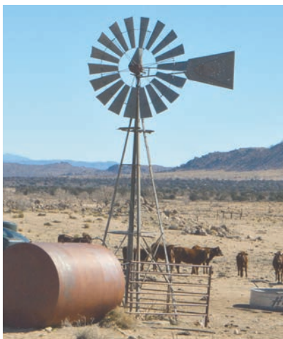
ภาพที่ 1.30 รูปทรงใบกังหันลมโคนเล็กกว่าปลายใบกังหันลม
