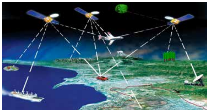
ภาพที่ ๑.๓๓ ส่วนผู้ใช้ ในการระบุตำแหน่งนั้นจะใช้หลักทรงกลม ซึ่งตำแหน่งของดาวเทียม ๓ ดวงจะทำการคำนวณระยะทางจากดาวเทียมมายังเครื่องรับสัญญาณ คือ ระยะทาง = ความเร็ว x เวลา ทำให้ได้พิกัดของสถานที่ ที่มา: https://goo.gl/images/VGGCqv
