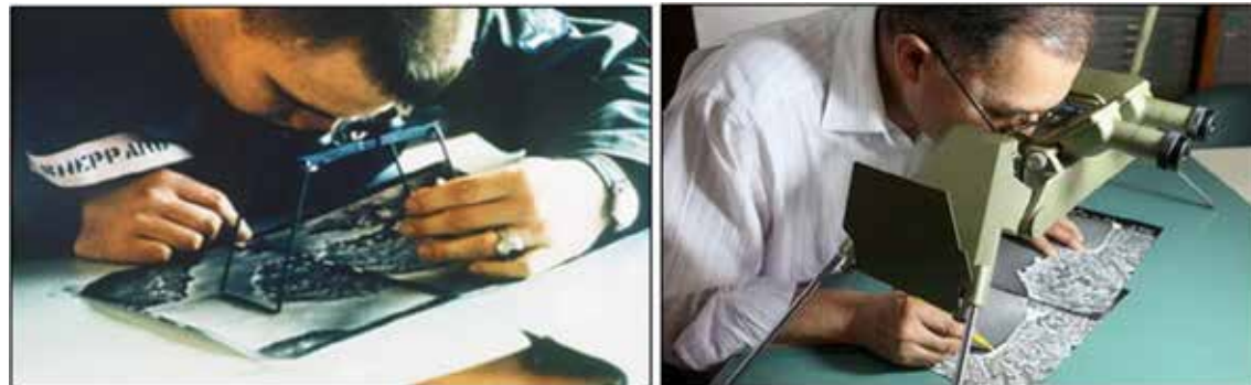
ภาพที่ ๑.๔๑ การแปลความรูปถ่ายทางอากาศด้วยสายตาโดยใช้อุปกรณ์ประกอบ แวนมองภาพสามมิติชนิดพกพา ในภาพซ้าย และในภาพขวาเป็นกล้องมองภาพสามมิติแบบกระจกสะท้อน
