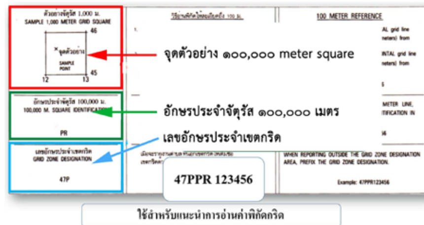
ภาพที่ ๑.๑๒ รายละเอียดของข้อมูลในการอ่านค่าพิกัด ตัวอักษรประจำจตุรัสแนมตร ที่มา: กรมแผนที่ทหาร, ๒๕๕๔
