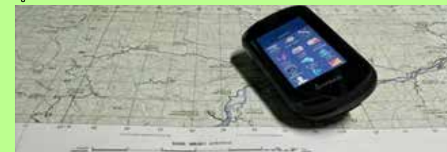
ภาพที่ ๑.๒๙ แผนที่ภูมิประเทศ ชุด L7018 มาตรฐาน 1 : 50,000 และเครื่องรังวัดค่าพิกัดจากดาวเทียม ต่างเป็นเครื่องมือที่ใช้ในการกำหนดตำแหน่งบนโลกและมักถูกใช้ประกอบกัน
