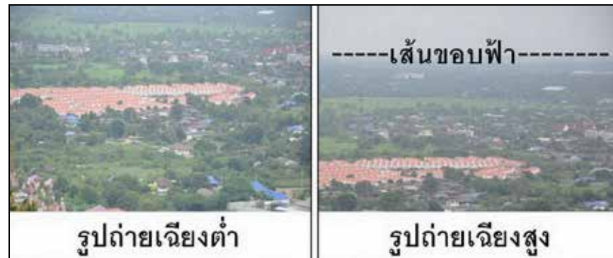
ภาพที่ ๑.๒๓ เปรียบเทียบระหว่างรูปถ่ายเฉิงต่ำกับรูปถ่ายเฉิงสูง
