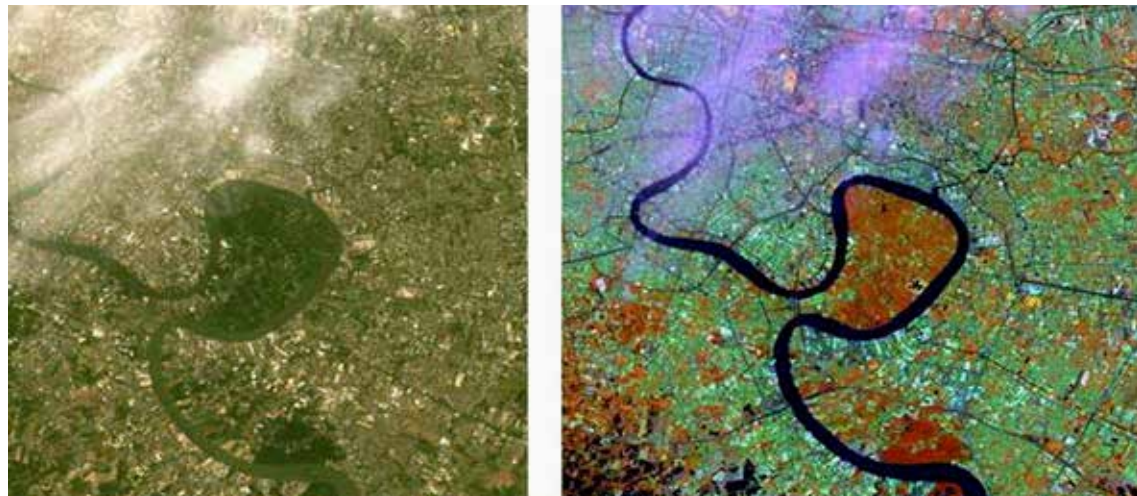
ภาพที่ ๑.๒๗ ตัวอย่างภาพจากดาวเทียม Landsat - 8 บริเวณบางกระเจ้า กรุงเทพมหานคร ภาพซ้ายเป็นภาพสีธรรมชาติ ส่วนภาพขวาเป็นภาพสีเท็จที่ให้พืชเป็นสีแดงเพราะตามนุษย์ไวต่อคลื่นแสงสีแดง ทำให้ช่วยแยกพืชแต่ละชนิดออกจากกันได้ ส่วนที่เห็นเป็นสีขาวบริเวณมุมบนซ้ายคือเมฆซึ่งบดบังรายละเอียดบนภาพบางส่วน
