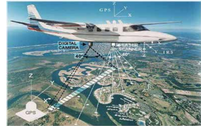
ภาพที่ ๑.๒๑ เครื่องบินถ่ายรูปทางอากาศติดตั้งกล้องถ่ายรูประบบเชิงเลข (digital camera) และเครื่องกราดภาพชนิดเลเซอร์ (laser scanner)
