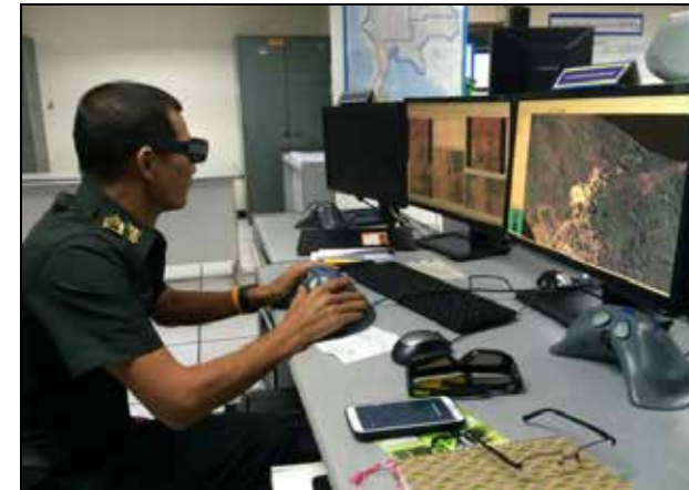
ภาพที่ ๑.๔๒ การแปลความหมายและทำแผนที่จากรูปถ่ายทางอากาศด้วยคอมพิวเตอร์
