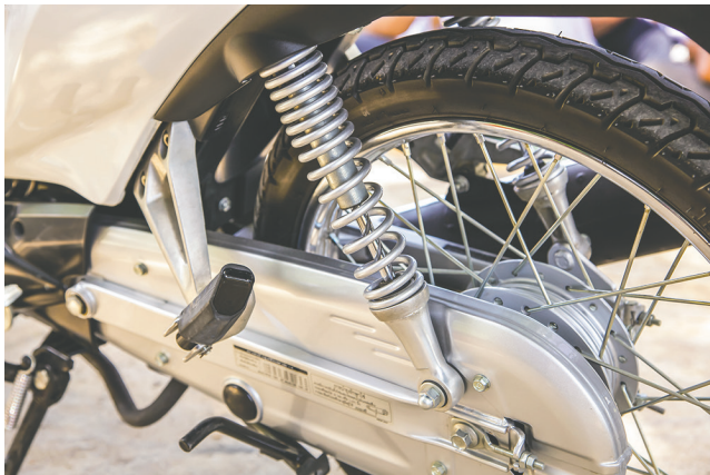
▲ ภาพที่ 1.60 โช้กอัพที่อยู่บริเวณล้อรถจักรยานยนต์จะช่วยรองรับแรงกระแทกและลดแรงสั่นสะเทือน เมื่อขับขี่ไปบนถนนที่มีผิวขรุขระหรือหลุมบ่อ จึงถือว่าเป็นอุปกรณ์ที่ช่วยเสริมความปลอดภัยแก่ผู้ขับขี่ ที่มา : คลังภาพ อจท.
